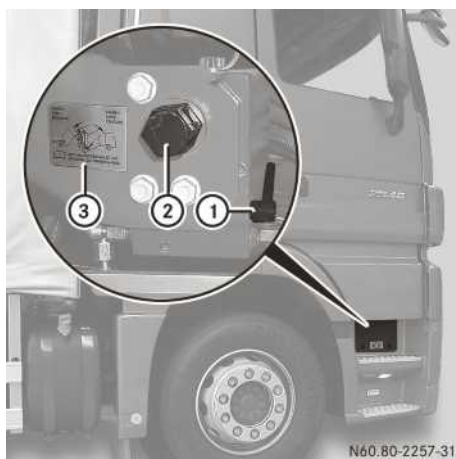
Pompa układu podnoszenia z prawej strony przy wejściu za klapą (przykład)
