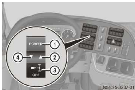
Przełącznik trybu Power/ EcoRoll (pojazdy bez Turbosprzęgła)
