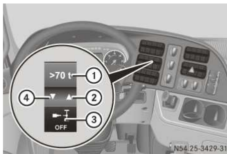
Przełącznik trybu > 70 t/ trybu EcoRoll, pojazdy ze sprzęgłem hydrokinetycznym (Turbosprzęgło)
