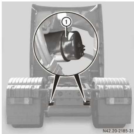
Siłownik sprężynowy ze śrubą zwalniającą i wskaźnikiem zwolnienia
