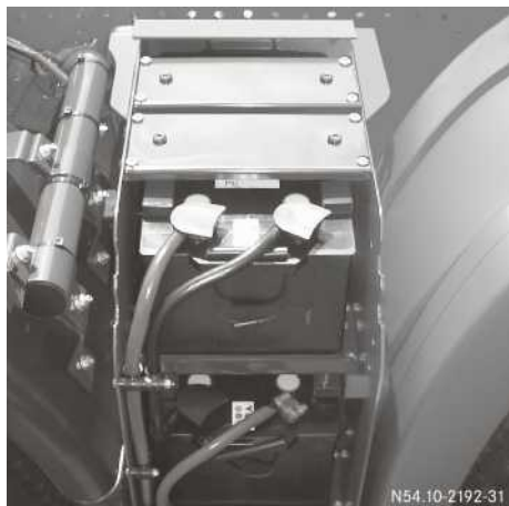
Wspornik akumulatorów z boku ramy pojazdu – akumulatory nad sobą (przykład)
