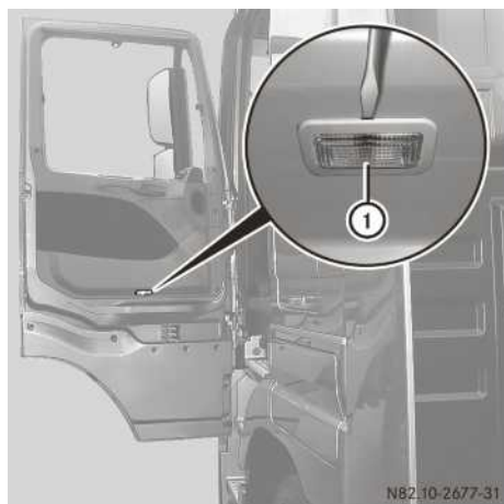
Lampa oświetlająca wejście (przykład)
