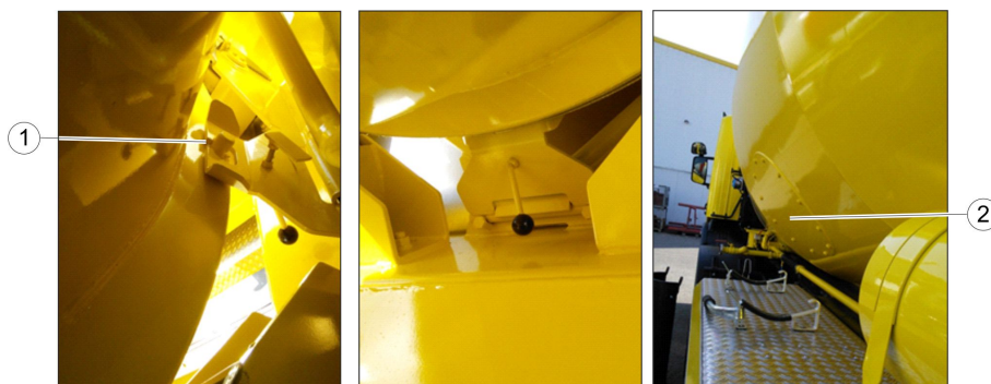
Rysunek 44: Włączony mechanizm blokujący bęben mieszarki
