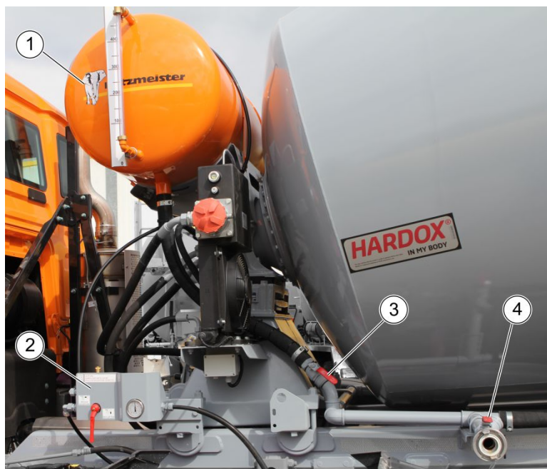
Rysunek 18: System wody pod ciśnieniem
