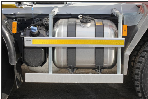
Rysunek 31: Boczne zabezpieczenie przed wjechaniem pod pojazd
