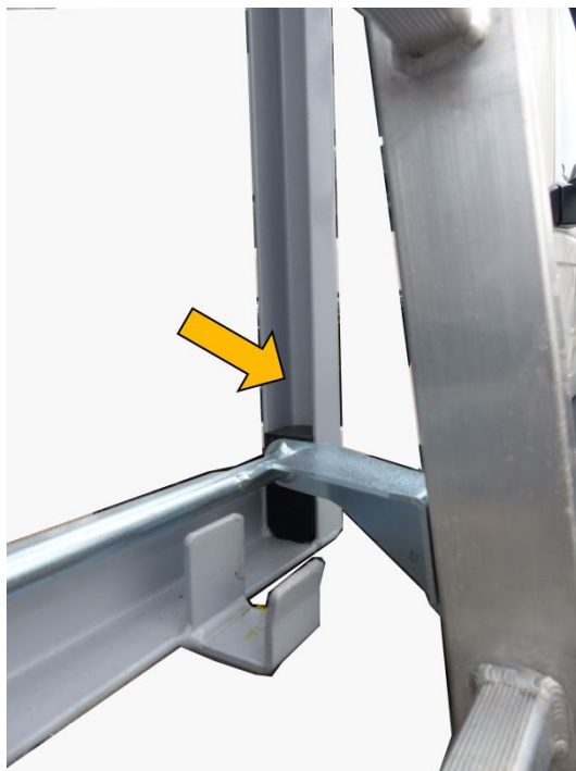
Rysunek 63: Punkty smarowania na prowadnicy kabla
