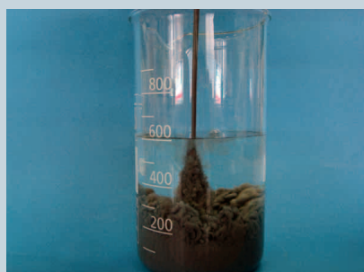
Fotografia przedstawia „opadanie” zaczynu do wody = segregacja
