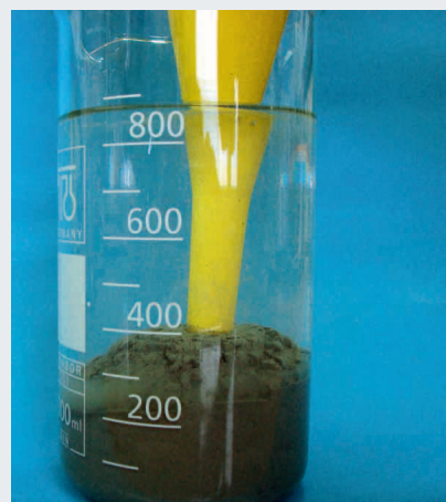
Fotografia przedstawia proces „betonowania podwodnego”; zaczyn jednorodny
