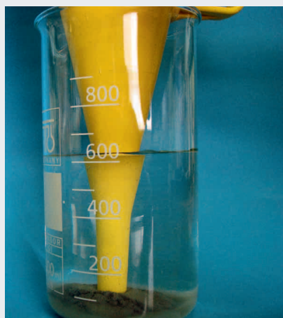
Fotografia przedstawia proces „betonowania podwodnego”; zaczyn jednorodny
