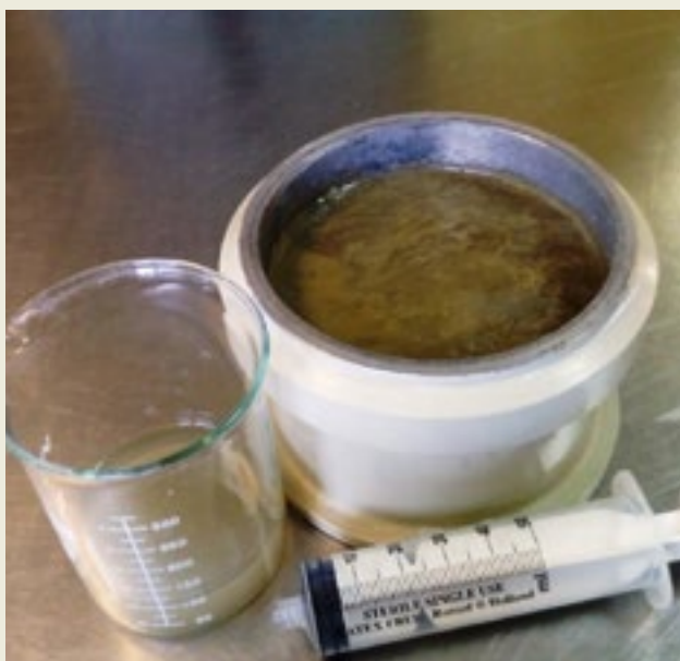
Rys. 3. Zbieranie wody z powierzchni mieszanki betonowej
