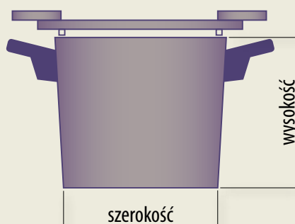
Rys. 2. Pojemnik na próbkę betonu
