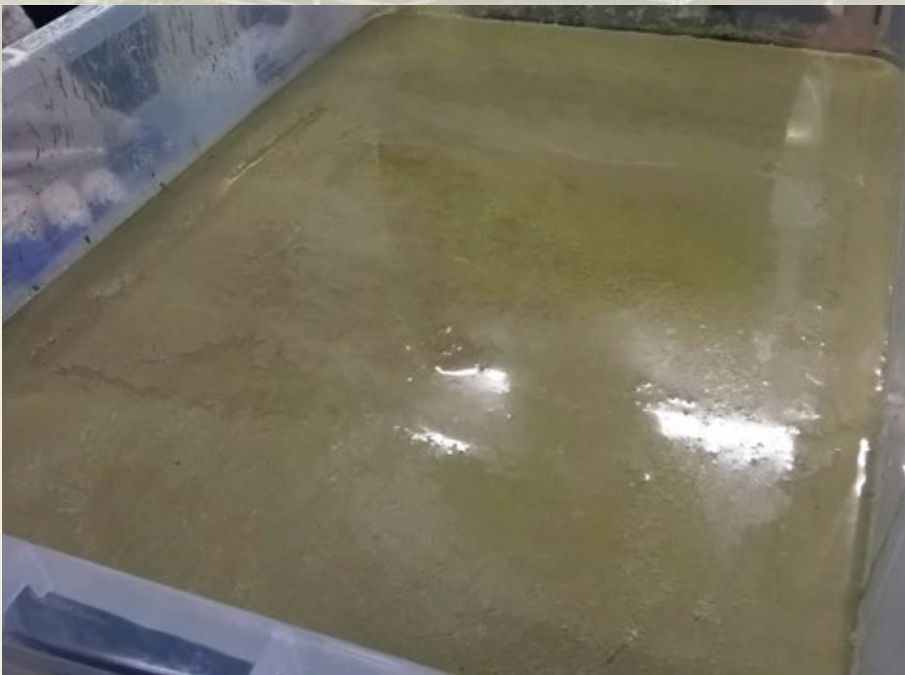
Rys. 5. Typowy przykład wydzielania się wody na powierzchni mieszanki betonowej
