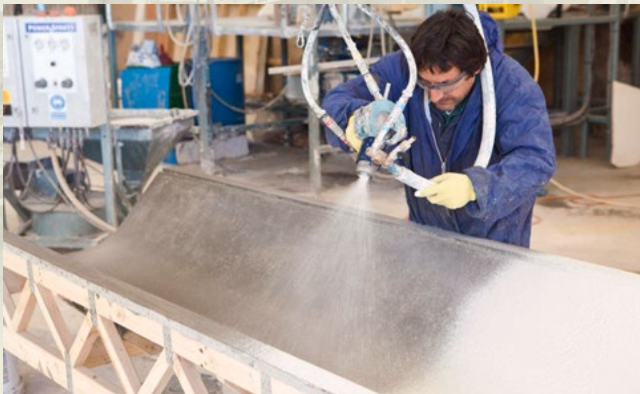
Rys. 7. Produkcja prefabrykowanych płyt GRC
