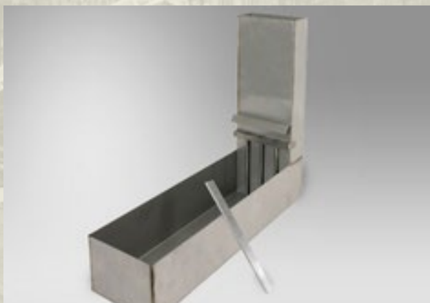
Rys. 7. L-pojemnik do badania przepływalności mieszanki betonowej SCC
