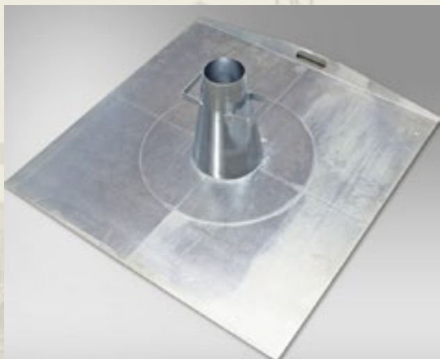
Rys. 3. Stożek do pomiaru konsystencji mieszanki betonowej SCC
