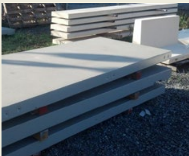
Rys. 12. Przykłady zastosowania mieszanki betonowej SCC w prefabrykacji
