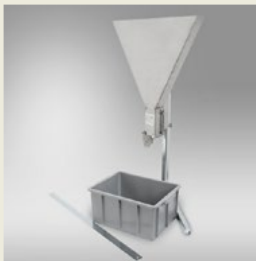
Rys. 6. V-Lejek do badania lepkości mieszanki betonowej SCC
