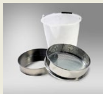
Rys. 9. Urządzenia do badania odporności na segregację mieszanki SCC
