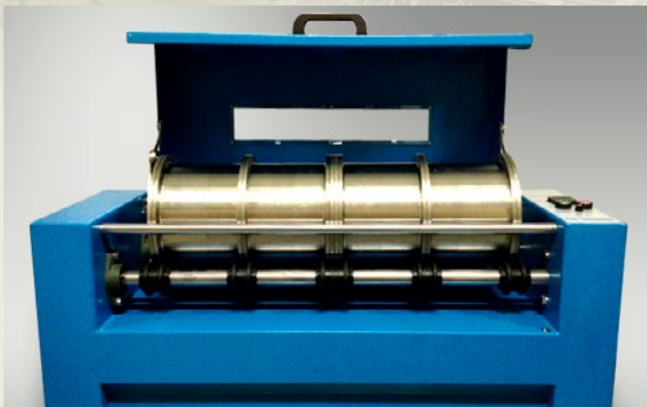
Rys. 3. Bęben mikro-Deval (widok komory roboczej)
