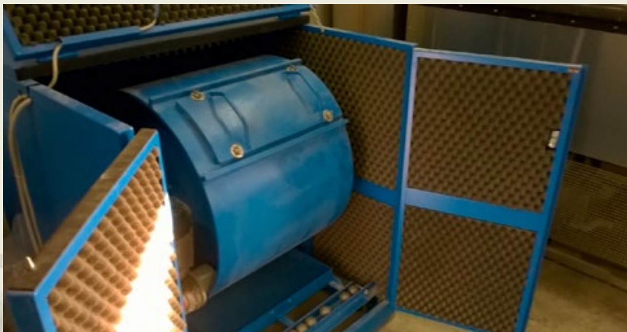
Rys. 2. Bęben Los Angeles do badania odporności kruszywa na rozdrabnianie
