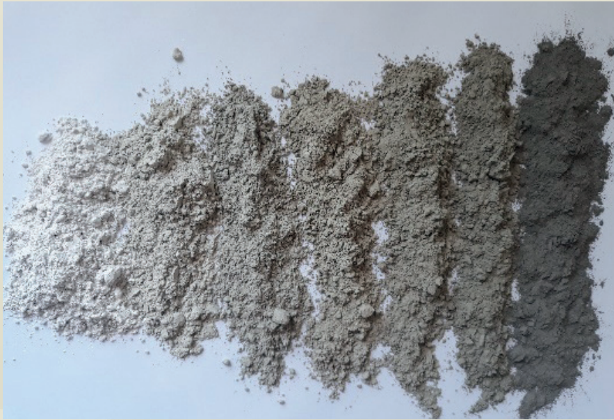
Rys. 2. Odcienie barw cementów oraz popiołu lotnego stosowanego w betonie. Od lewej: mielony granulowany żużel wielkopiecowy, CEM III/B 42,5L - LH/SR/NA, CEM III/A 42,5N - LH/HSR/NA, CEM II/B-S 32,5R-NA, CEM II/A-S 52,5N, CEM I 42,5R, popiół lotny krzemionkowy jako dodatek typu II
