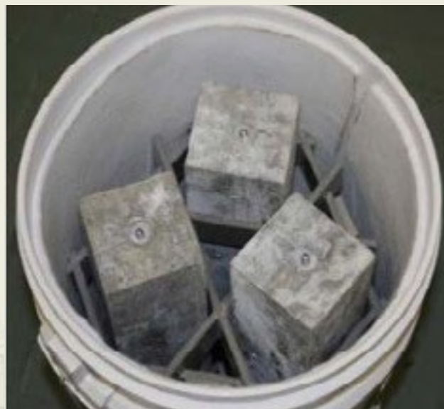
Rys. 8. Przechowywanie próbek wg metody ASTM C1293
