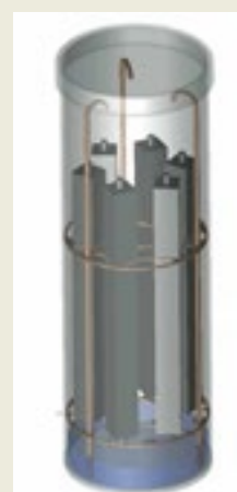
Rys. 6. Sposób przechowywania próbek wg ASTM C227
