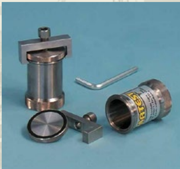
Rys. 3. Cylinder do badania kruszyw wg ASTM C289
