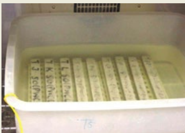
Rys. 5. Próbkę zapraw stosowane w metodach przyspieszonych
