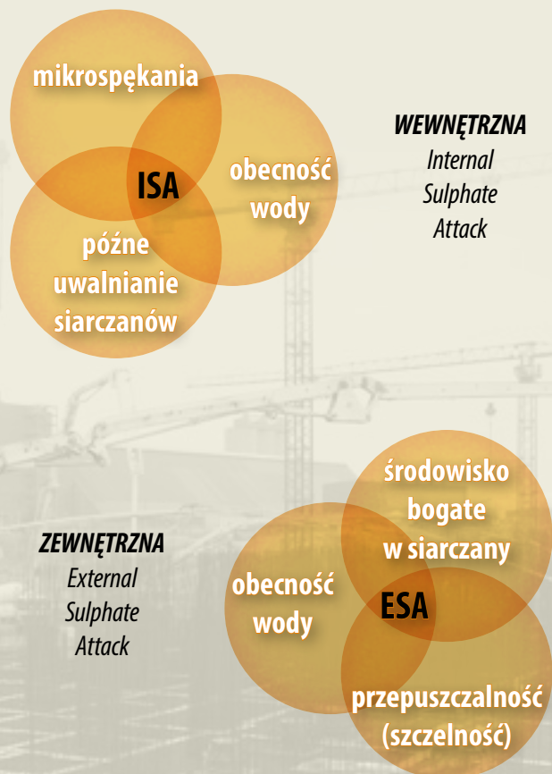
Rys. 5. Rodzaje i przyczyny korozji siarczanowej
