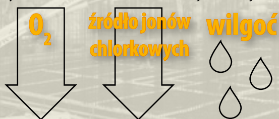
Rys. 4. Mechanizm niszczenia betonu w wyniku korozji chlorkowej
