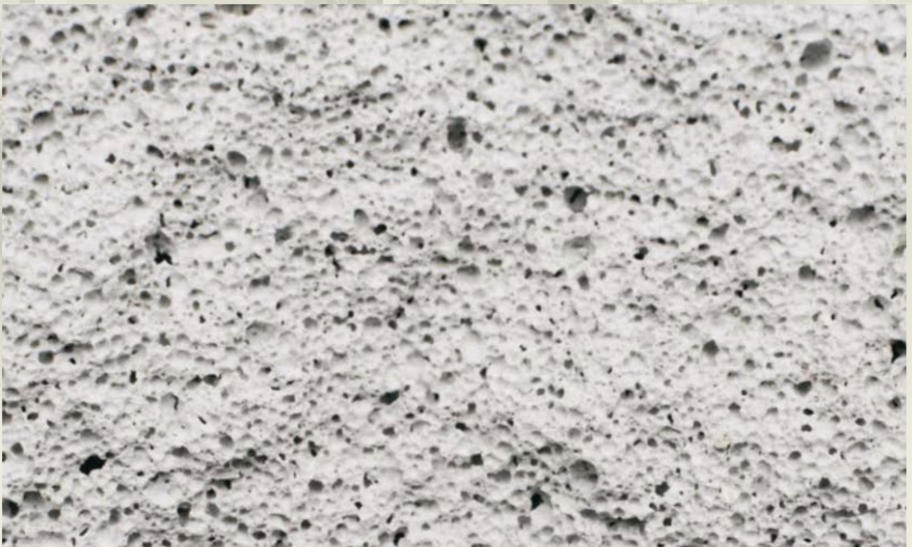
Rys. 2. Struktura betonu komórkowego
