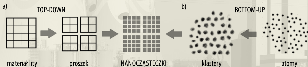
Rys. 4. Schemat syntezy nanocząstek a) metoda „top-down” b) metoda „bottom-up”
