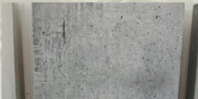
Rys. 3. Wpływ zastosowania piasku o niskiej zawartości frakcji poniżej 0,25mm (4,5%) na jakości powierzchni elementu referencyjnego
