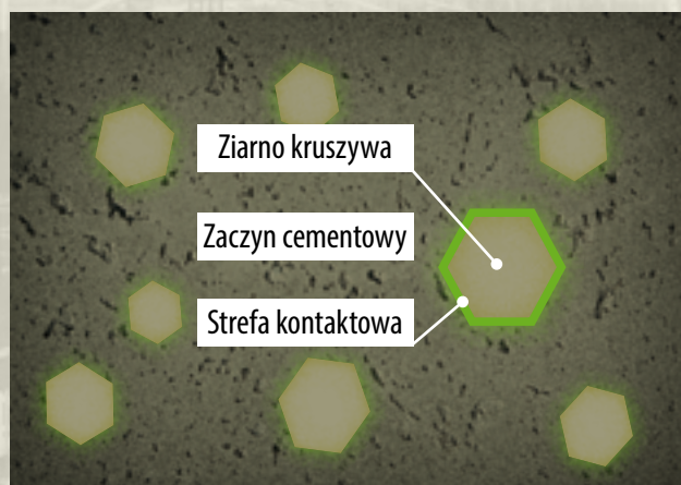
Rys. 2. Uproszczony model betonu
