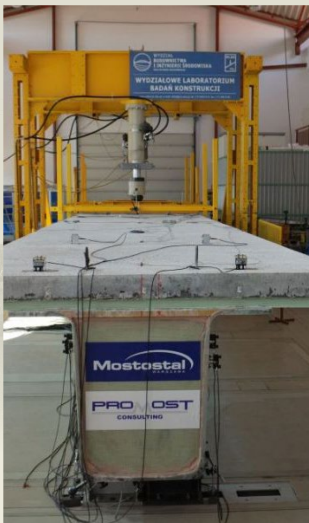
Rys. 12. Płyta pomostu z betonu lekkiego
