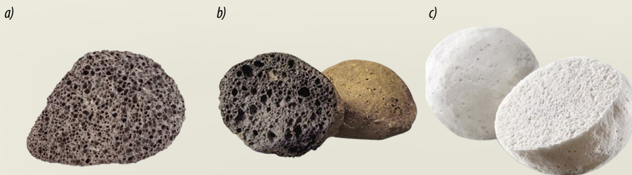
Rys. 4. Kruszywo lekkie a) naturalne - ziarno pumeksu, b) sztuczne z surowców mineralnych - spiekane z glin pęczniejących, c) odpadowe - szkło ekspandowane
