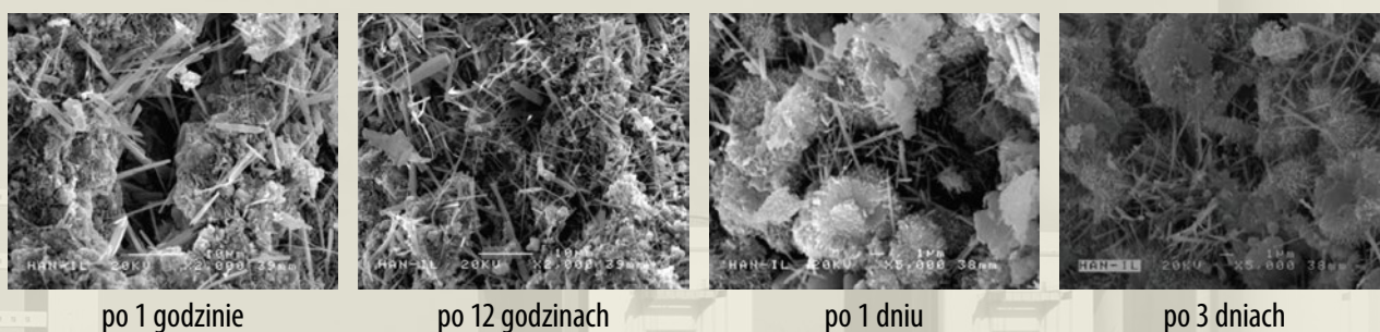
Rys. 4. Przebieg reakcji hydratacji i zmian w mikrostrukturze twardniejącego cementu siarczanoglinianowego CSA
