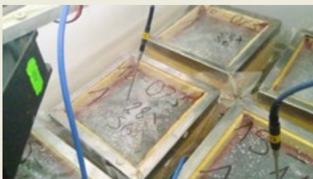
Rys. 5. Próbkę betonu podczas badania mrozodporności powierzchniowej
